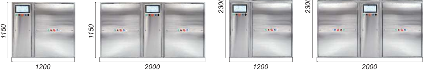
Модуль накопления и обработки допускает как левостороннее, так и правостороннее размещение относительно инженерного модуля.
